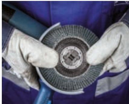
Drücken Sie das Werkzeug leicht nach unten, bis es hörbar einrastet.
