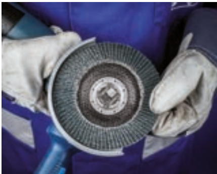
Setzen Sie das Werkzeug formschlüssig auf die X-LOCK-Aufnahme.
